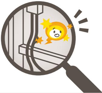
コンセントのみを対象にしたトラッキング対策とは異なり、ノイズに反応する放電検出ユニット「スパークテクト」は、コンセントやコードはもちろん、壁内配線など“目視できない箇所”で発生した火花放電も検出できることが特長です。築年数の経った建物など、壁内配線の劣化が心配なところでは放電検出ユニット「スパークテクト」の設置が効果的です。
