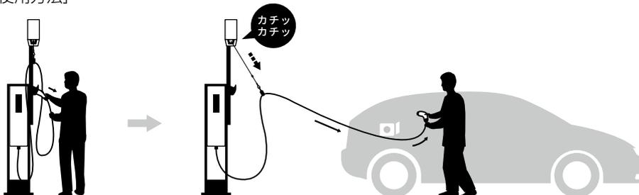
充電コネクタケーブルを持って、必要長さを引き出し、カチッカチッと音のするところで止めるとストッパーが掛かります。使用後は、カチッカチッと音がしないところまで少し引き出すと、自動で巻き戻します。
